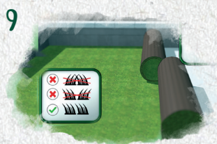
9 Colocar los rollos de césped, con el pelo en la misma dirección
